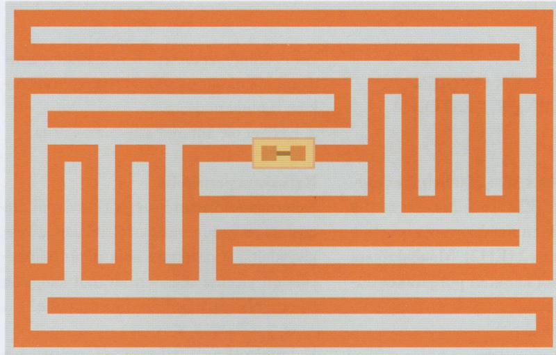
RFID-muistisiru upotetaan korttiin valmistusvaiheessa mutta se voidaan kiinnittää alustaan myös tarralla. Kuva: Sakurambo
